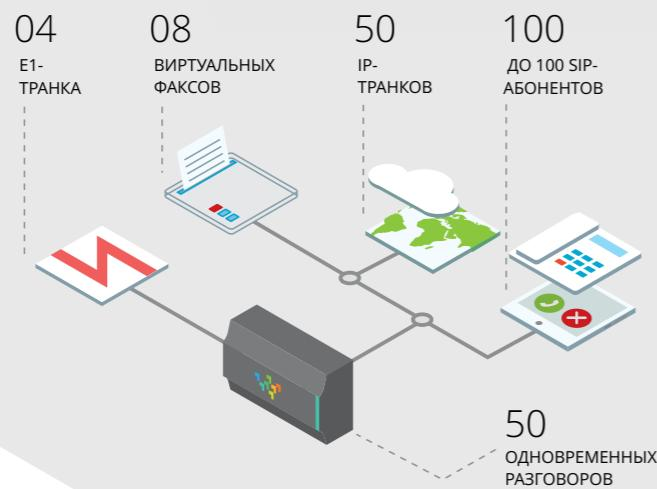
Symway® Hybrid SZ1900 E1 — гибридная пириговая АТС, обеспечивающая подключение по потокам E1. Предназначена для среднего и крупного бизнеса, государственных структур и операторов связи.
