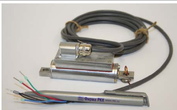
Рис. 4. Внешний вид струнного датчика деформации в водостойком исполнении
